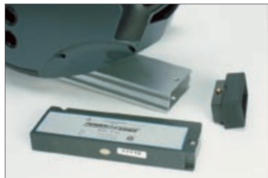
Die Batterien können während der Vermessung ausgewechselt werden ohne Verlust der Messdaten.
