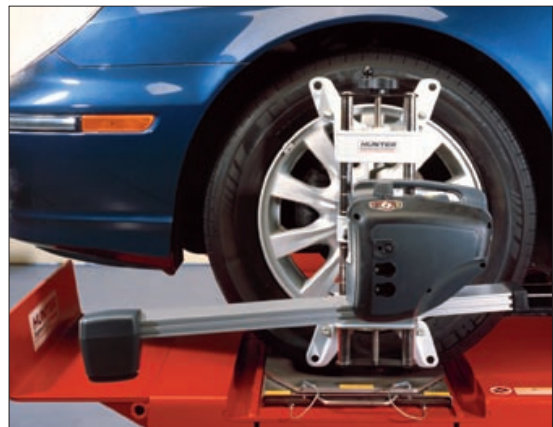
DSP500XF kabellose Mess-Sensoren bieten Datenübertragung in der gleichen Geschwindigkeit wie herkömmliche Mess-Sensoren jedoch ohne Kabel-Wirrwarr.
