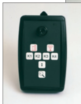
DSP600 mit optionaler Fernbedienung Niveauhöhenmesser für VAS 6292
