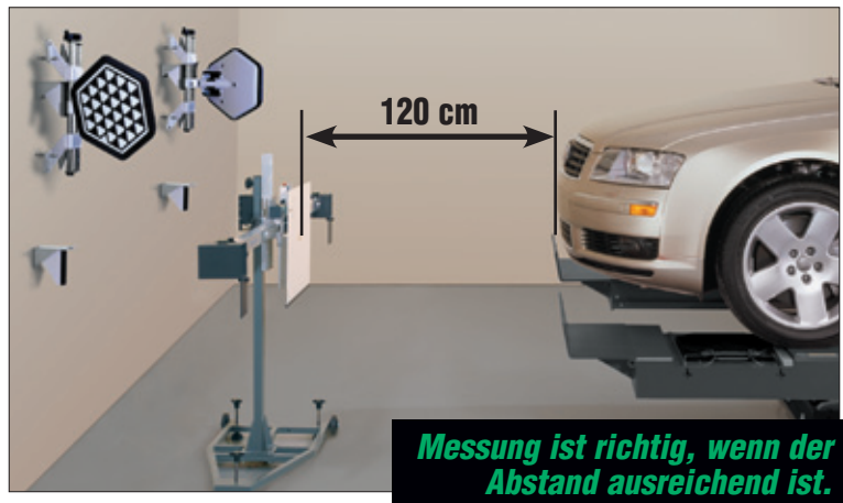
Abb.: ADR/ACC Messung Optionale DSP600 Sensoren
