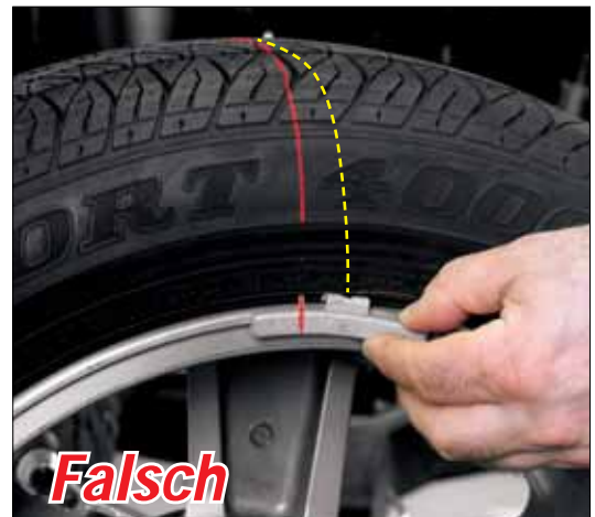
HammerHead reduziert Fehler bei der Anbringung der Schlaggewichte unter Verwendung der TDC Positionierung, unnötige Kontroll- Läufe werden vermieden.
