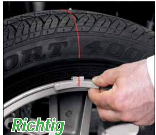
Präzise Anbringung des Ausgleichgewichtes einfach und schnell durch den TDC Laser als Markierung.
