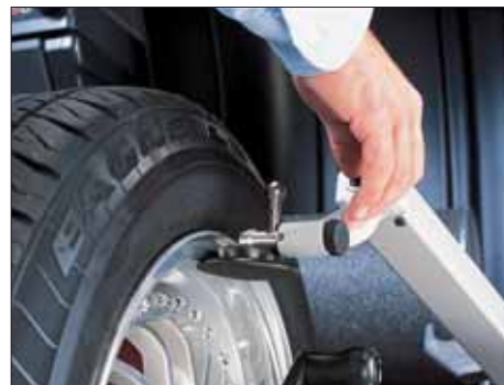
Der Felgenrundlauf kann gemessen werden, ohne dass der Reifen demontiert wird...
