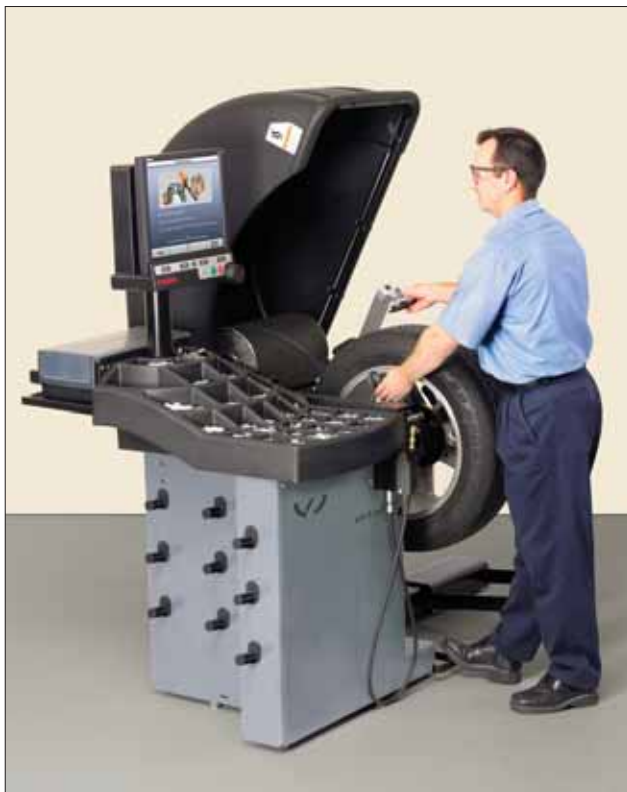
VAS6230A Abb. mit optionalem Drucker mit Ablage (VAS6230A/1 und optionalem Reifenlift VAS6230A/2)
